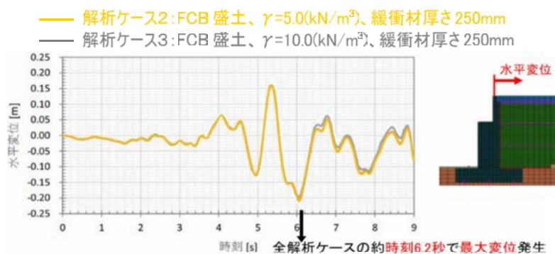
図-2 橋台頂部の水平方向変位の時刻歴応答
